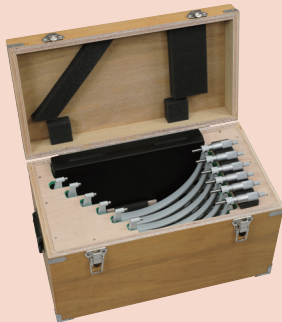
103-915-10 OMST2-300 ●测量范围: 150~300mm ●套装内容: 25mm 间隔6个 150~275mm带25mm的量杆6个 本图仅供参考, 以实物为准
